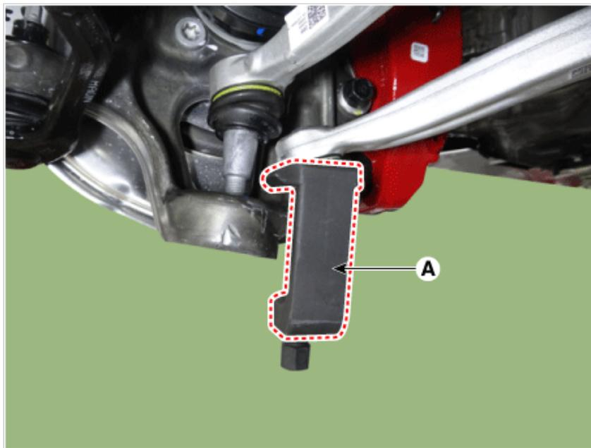
7. Remove the tie rod end nut.
